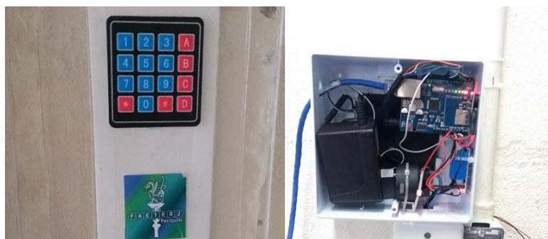
Figura 4.3: Teclado utilizado e o Arduino instalado com o shield e módulos ligados a ele.
